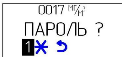
Рисунок 2.4 – Вид меню ввода пароля для перехода в режим специальных функций (редактируемый разряд пароля обозначается инвертированным символом).
