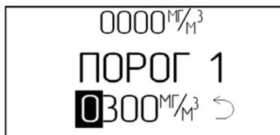
Рисунок 2.6 – Меню редактирования порогового значения срабатывания сигнализации (редактируемый разряд порогового значения выделен инвертированием)
