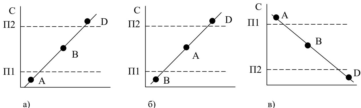
Зона А – диапазон содержания определяемого компонента, при котором не происходит срабатывания сигнализации;
