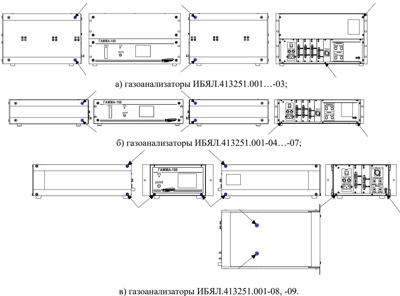
Стрелками указаны места пломбировки от несанкционированного доступа и
