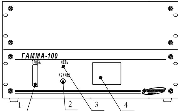
а) газоанализаторы ГАММА-100 (три измерительных канала)
